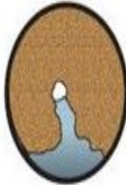
**La acumulación excesiva restringirá el flujo de wastewater y puede tener como resultado una capacidad excesiva sanitaria de alcantarilla.**
